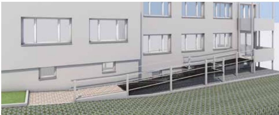
Visualisierung (Planung) der Rampenkonstruktion Eiselstraße 111
